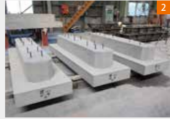
養生後型枠を外し、完成
