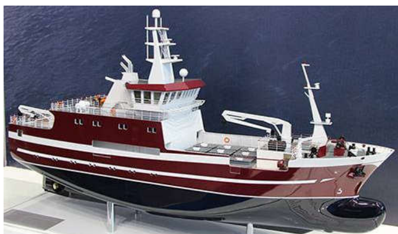
Рис. 3. Судно для добычи краба проекта 03070
