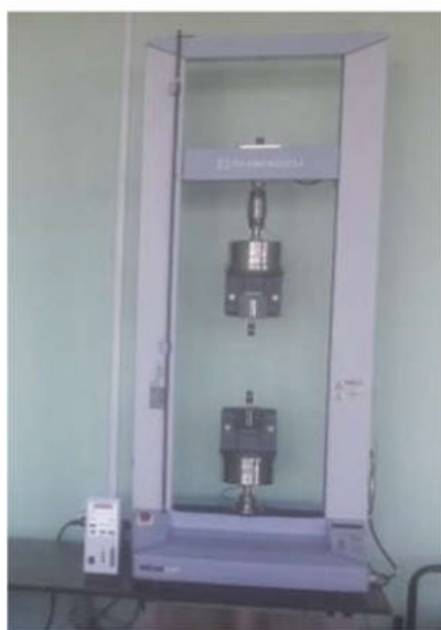
Рис. 2. Универсальные разрывные машины Shimadzu Autograph AGS-X10
