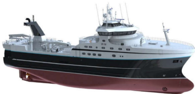
Рис. 4. Средний рыболовный траулер проект ST 118
