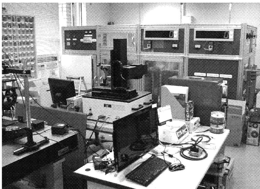
大分県産業科学技術センターは永久磁石材料の磁化特性を測定する評価装置などがそろった。
