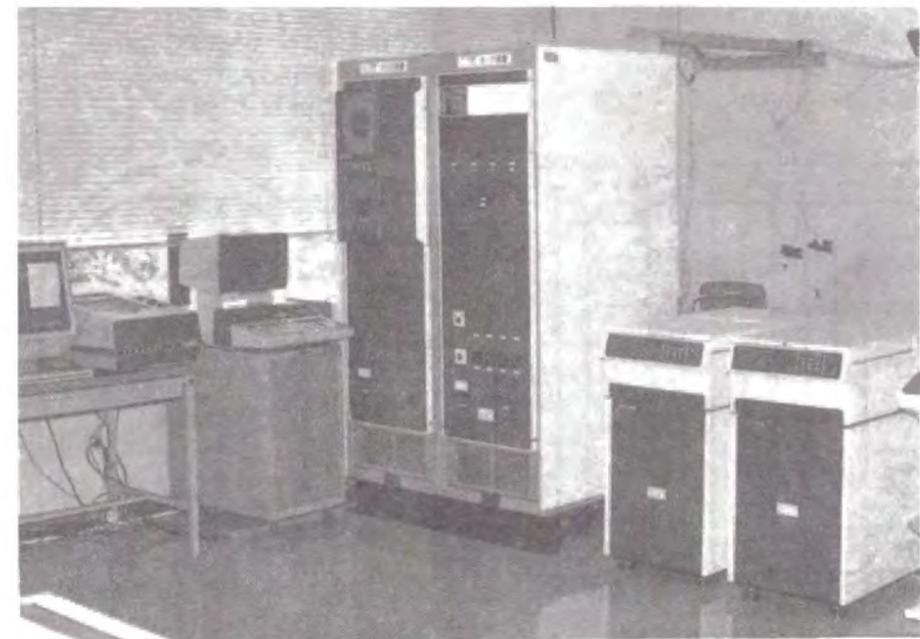
写真3-1 データ収集システム(筑波センタ内)
