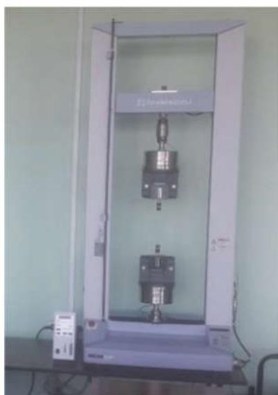
Рис. 2. Универсальные разрывные машины Shimadzu Autograph AGS-X10
