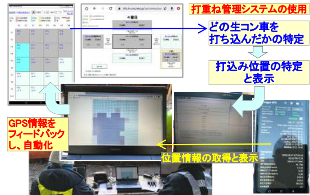
図-14 実施工における作業履歴の表示例
