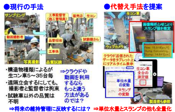
図-1 コンクリートの現場受入れに全数検査を導入
