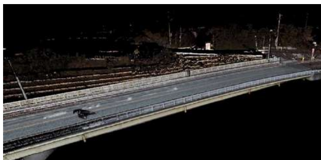
図-4 MMSとZenmuse L1で計測した点群データの合成・重ね合わせ
