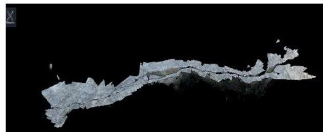
図-4 iPhoneによるクラックの点群測量結果
