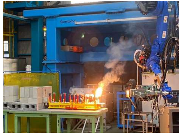
図-1 高出力レーザーによるコンクリートの溶断実験
