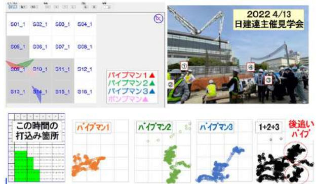
図-11 実施工における作業履歴の表示例
