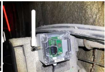
図-4 無給電・無線電力センサ
