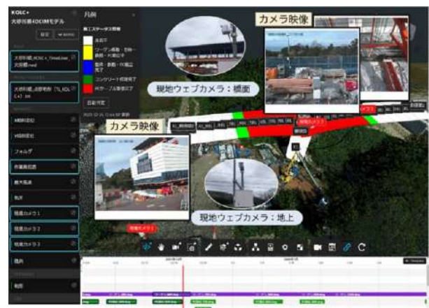
図-4 計測機器とBIM/CIMクラウドの連携
