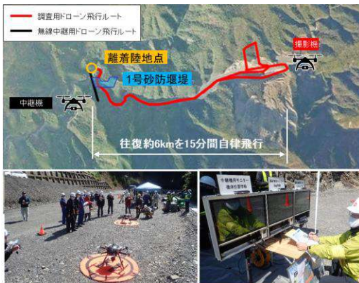
図-4 上； UAVの飛行ルート、下； 離発着地点と地上局
