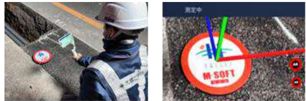
図-6 ARアプリを用いた評定点の抽出
