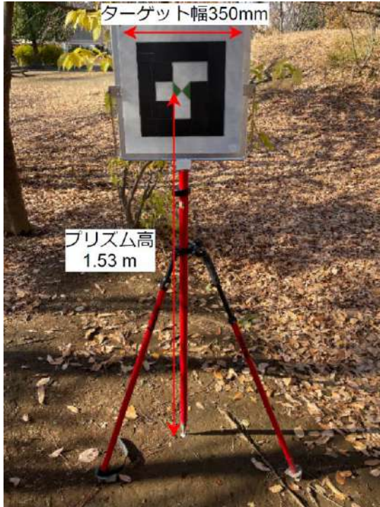
図-1 再帰反射材を用いたターゲットマーカ
