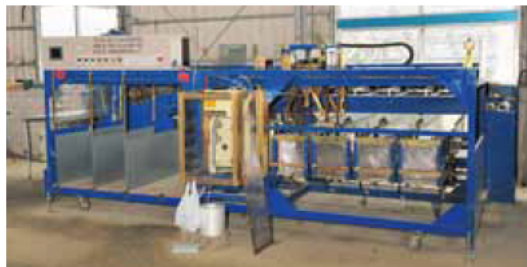
自動結束ロボット付重量選別機。通称・花ロボット
