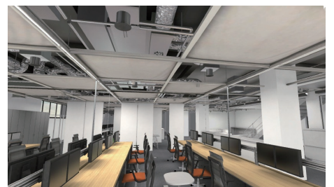
「オフィス」のCGパース:天井フレームの採用により柔軟なオフィスレイアウトに対応。膜放射空調も設置
