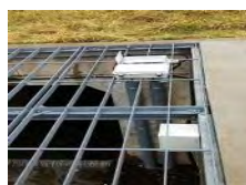
親水施設型の雨水調整池『アクアテラス』における水位・水質・水温計測
