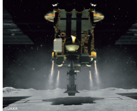
「はやぶさ2」探査機イメージ。「はやぶさ2」では小惑星リュウグウの惑星の表面に探査機から弾丸を当て、舞い上がった物質を「サンプラーホーン」という筒で回収する採取方法をとる。サンプル回収の機会が3回で、「数百mgでも回収できると嬉しい」と藪田准教授。
