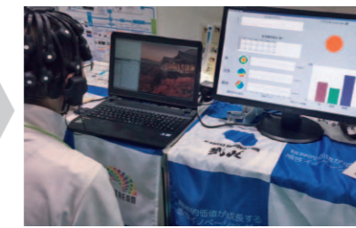
機能的MRI(fMRI)、光トモグラフィー、脳波、表情・脈拍・音声などの生理反応を同時計測し、人の感性をリアルタイムの脳情報として読み取り、感性(ワクワク感)を「見える化」する。
