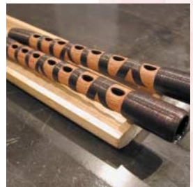
今井さんの手による現代の篳篥。削って指穴をあけた煤竹に、樺(桜皮)を細く削りて巻く。
