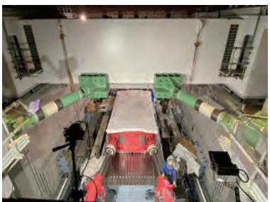
図6 反力梁の設置 (2022.12.21)
