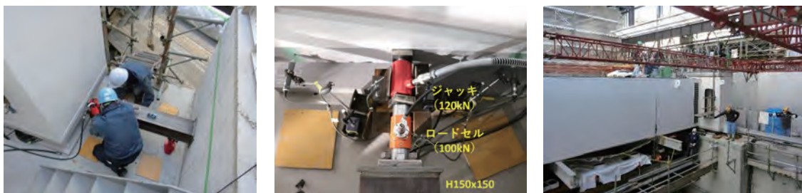
写真2 反力梁の剛性確認実験で計画した手で持てる装置と実験時の様子
