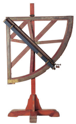
高象限儀中 天体観測器具 測量地の緯度を求 めるために、北極星などの高度を観 測した器具。
