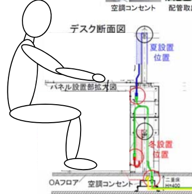
脱着式止水継手、空調コンセント
