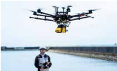
UAV レーザー測量
