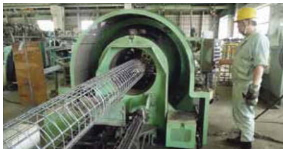
コンクリートポールを製造する(海邦工場)
