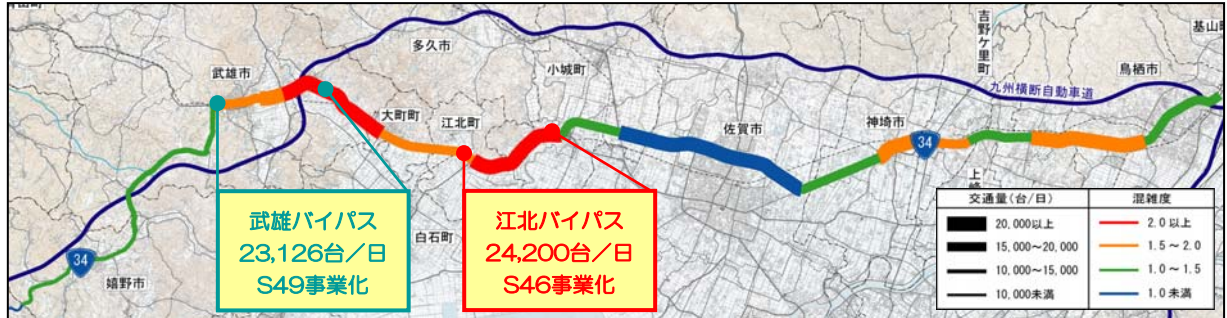
▼ 国道34号の区間別混雑度 (S55道路交通センサス)
