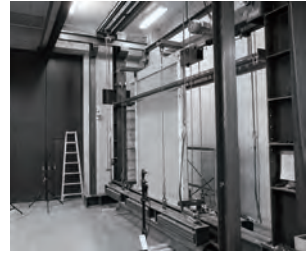
実大規模の京土壁の破壊実験の様子
