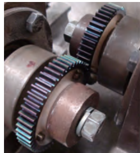
DLC膜を被覆したプラスチック歯車の運転試験の様子
