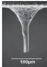
直径17ミクロンのマイクロドリルと 内径7ミクロンの穴あけ加工例
