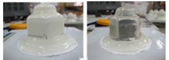
写真 1.b 左：完全充填 右：つばのみ充填
