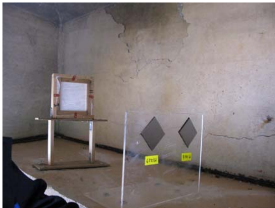
写真5 ドライガーゼ及び SMA 鋼板 センサ設置状況
