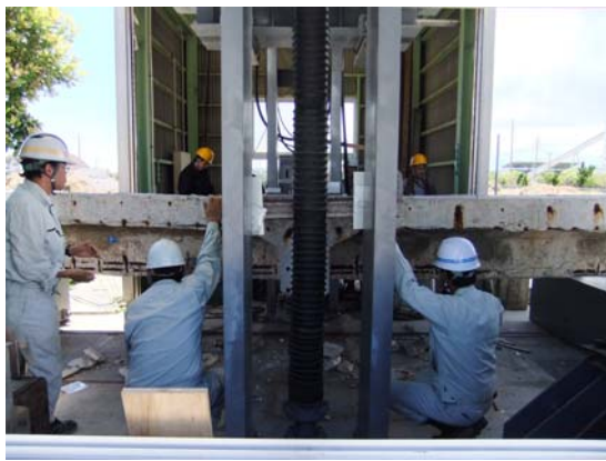
写真9 RC桁の載荷実験の状況
