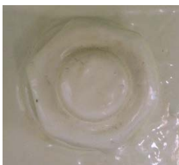
a) 防食便覧(刷毛塗り)
