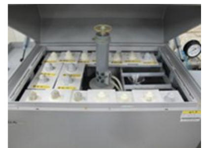
写真 2. 左：暴露試験場外観 右：塩水噴霧試験状況
