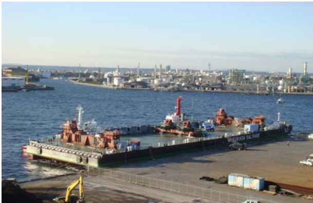
写真-2：輸送台船艀装状況
