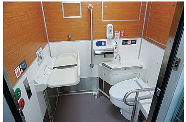
写真-4 車イス対応トイレ（4号車）
