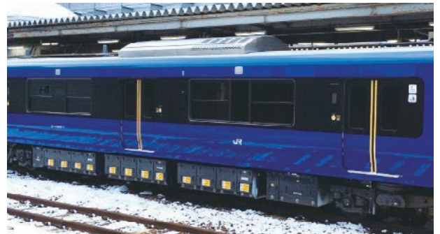
図4 Tc'車床下機器配置
