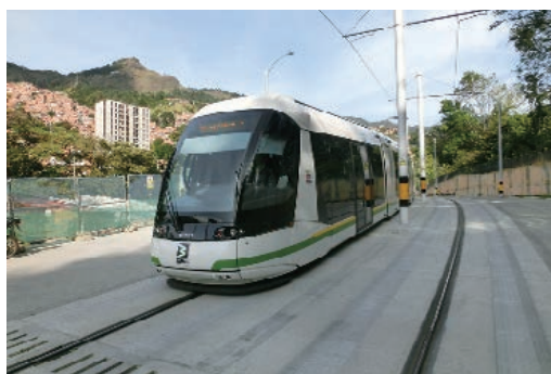
写真-23 ミラフローレス停留所に入線してくる都心行きのゴムタイヤ式トランビア。アルストム社製のトランスロールである。(2016年9月27日)
