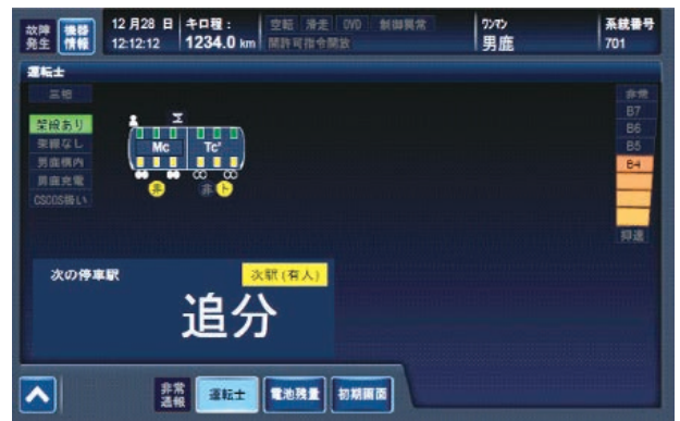
図13 モニタ表示器架線認識状態
