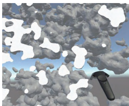
図 29 電子顕微鏡 (FIB-SEM) で観察してゴム中のナノ粒子の 3 次元構造[14]の断面カット VR 視聴画面の例
