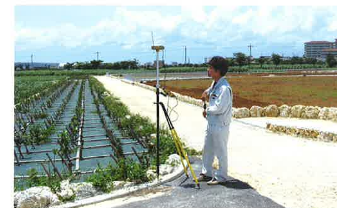
RTKによる基準点測量(4級)
