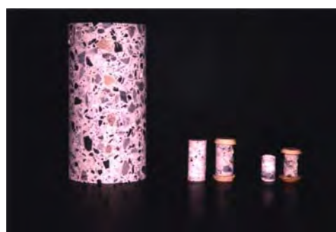
写真 3.4.3 \phi 100\text{mm} コアと小径コア
