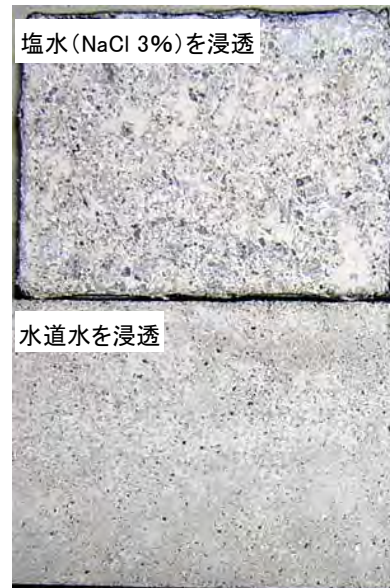
写真 2.1.11 塩水を浸透させた供試体の凍結融解試験 (300 サイクル)
