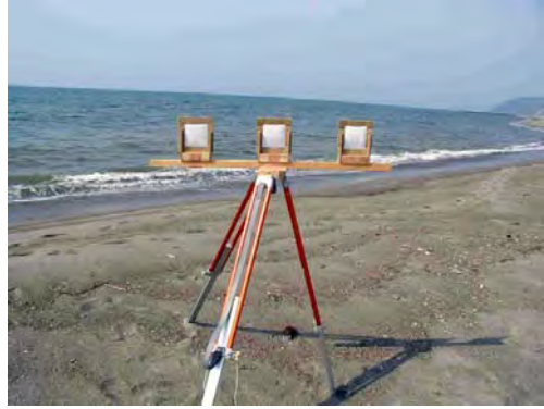
写真 3.5.1 ガーゼ法による飛来塩分の捕捉
