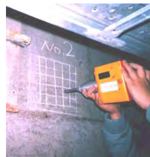
写真 3.4.2 シュミットハンマーによる反発硬度の測定
