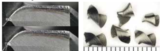
■ 使用 WHO55-5D 加工 508 个孔后的照片 After drilling 508 holes with WHO55-5D.
