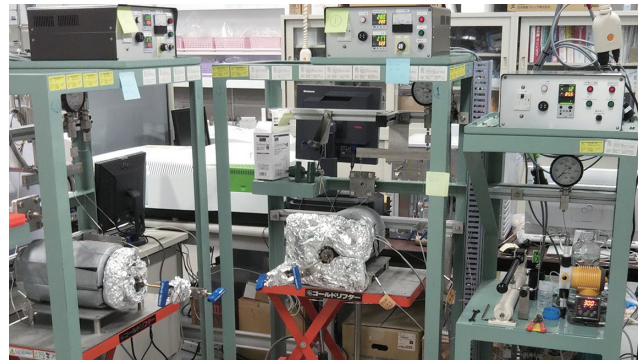
図 新規に構築した熱水反応装置。エウロパの海底熱水環境を模擬した300℃、1000気圧での反応を再現する。
