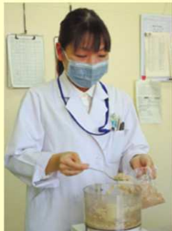
馬鈴しょをミキサーで粉砕して検体サンプルを作成
