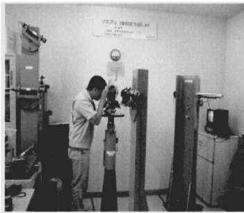
測量機検定室
