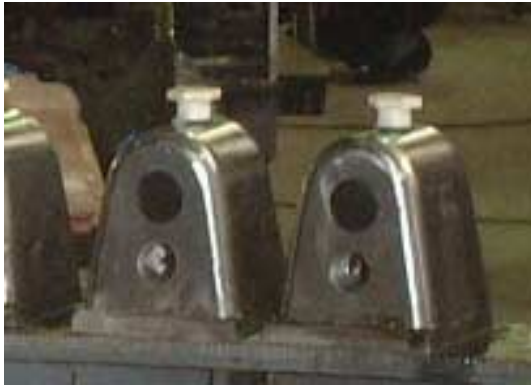
図－４ 樹脂パネル固定治具
