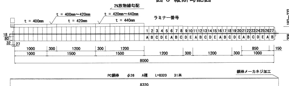
図-7 プレストレス木床版断面図
