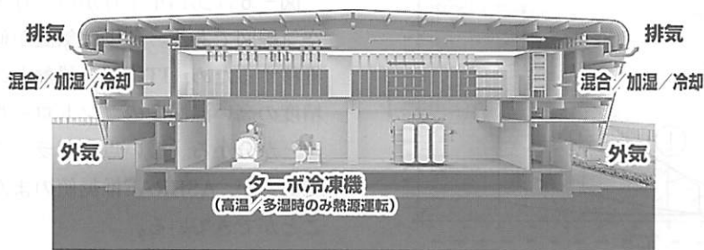
図-2 外気空調の仕組み
