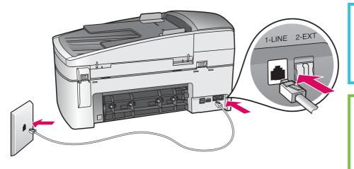
将电话线的一端连到左侧 (1-LINE), 进线)的电话端口中,然后将另一端 插入墙上的插孔中。
