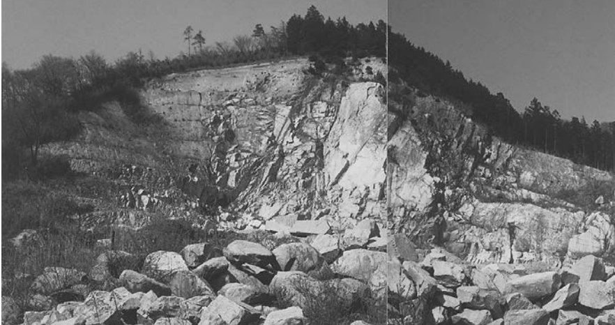
写真4. 細粒花崗閃緑岩体にみられる風化形態の例。 写真左はD級、右はCM～CH級岩盤。茨城県笠間市福原西方。
