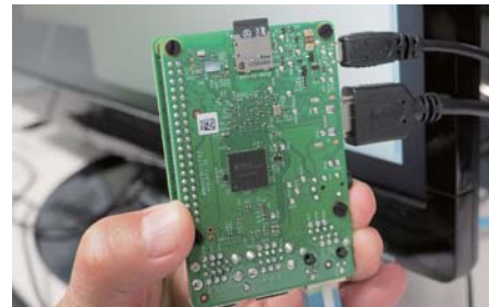
▲小さいながらCPUやメモリーなどが搭載された超小型パソコン「ラズベリー・パイ」の本体（左上）と本体裏側（下）、ワークステーションとの接続に使われたLAN用ハブ（右上）
