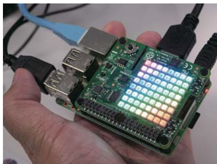
▲ラズベリー・パイにはLEDが8×8個並んだパネルを搭載しているほか、モニターやマウス用の端子、LANケーブル（水色）も接続できる
