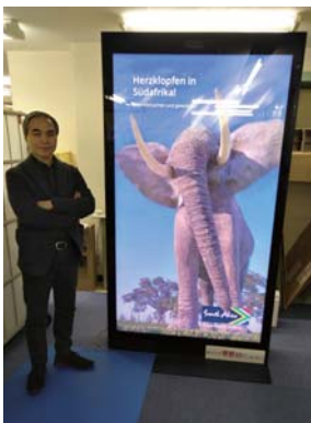
写真3（左） 縦型の85インチ（2100H x 1220V x 535D、325Kg）、筐体内に再生機能内蔵、4K解像度、4視点
