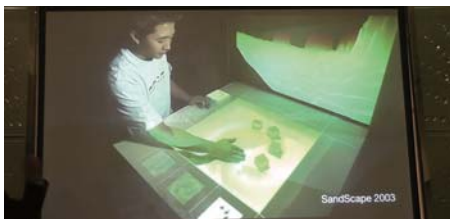
「SandScape 2003」。手で砂山の形を変えると、それに応じて等高線やヒートマップなどの映像がリアルタイムに投影される
