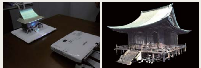
3Dプリンタで出力したモデルへの投影シミュレーション
