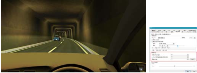
図6 トンネル内照明強度：0%設定
