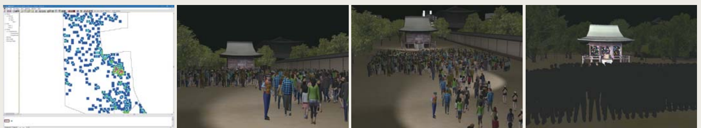
避難解析ソフトEXODUSによる解析結果 (左端) をVRで可視化した観客誘導シミュレーション
