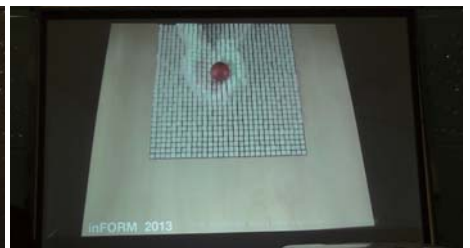
「inFORM 2013」のブロック盤装置。人間の手の動きを感知装置 (左) で検出すると、ブロック盤 (右) がそれに応じてリアルタイムに変形する
