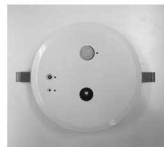
天井面設置の複合 (照度・温度・人感)センサ
