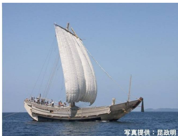
北前型弁才船「みちのく丸」 全長32 尺 、全幅8.5 尺 、千石積み（積載量150 石 ）
